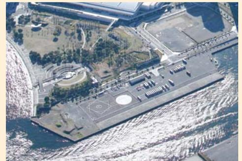
現況 … 耐震岸壁が完成し、後背地はヘリポートで暫定的利用が図られています。
